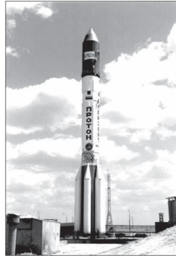
✓ **7 апреля 2001 года** состоялся первый пуск модернизированной ракеты 8К82КМ Протон-М с цифровой системой управления и новым разгонным блоком 14С43 Бриз-М. Это позволило заметно увеличить полезную нагрузку при выведении на геостационарные орбиты.
