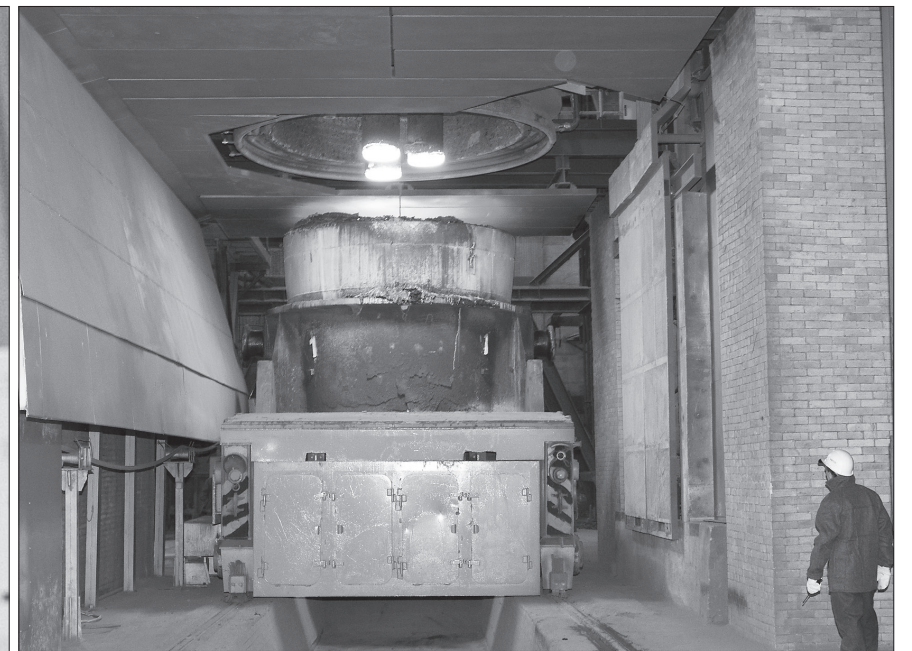
* Новый агрегат вмещает 153 тонны жидкого металла.
