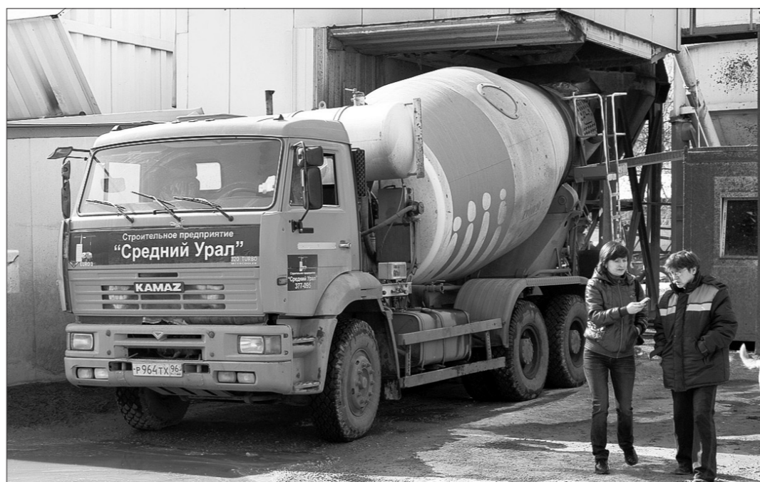
Идет отгрузка готового продукта в бетономешалку. Процесс полностью автоматизирован, нет никаких потерь.
