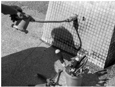
Поврежденная лампочка из системы подсветки.
