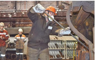
ча выполнить переход калибров при прокате круглой заготовки диаметром 100 и 90 мм, - поясняет Максим. - Мы должны правильно передвинуть выходные линейки и проводковую арматуру.
