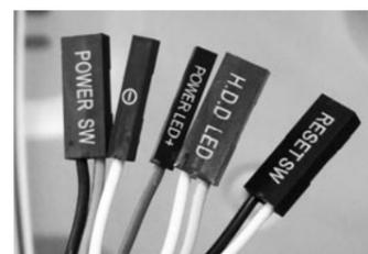
Power SW – кабель кнопки включения; Power LED + – кабель индикатора (лампочки) питания; HDD LED – кабель индикатора загрузки жесткого диска (та самая лампочка, которая обычно мигает); RESET SW – кабель кнопки перезагрузки.
