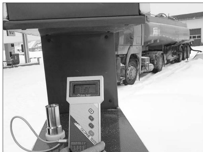
На автозаправочной станции бензин проходит входной контроль количества, плотности, замера октанового числа.
