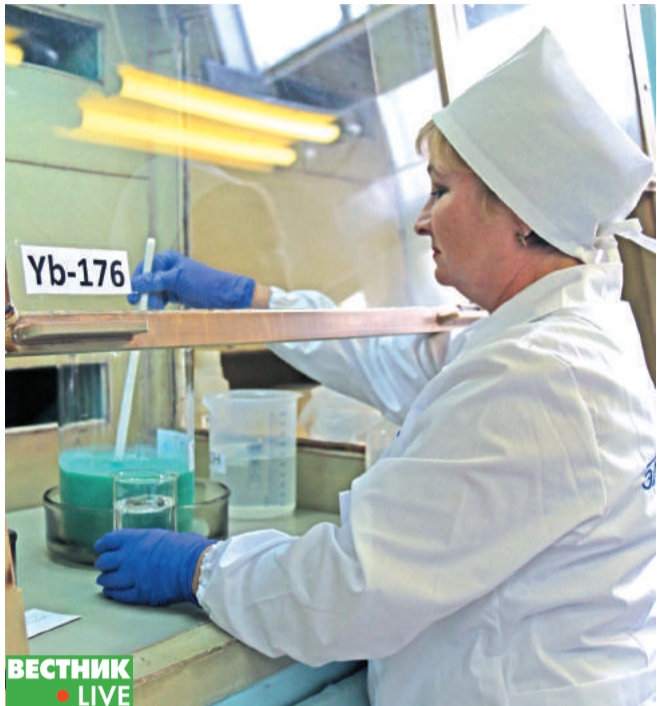
Лена Вискунова, аппаратчик производства изотопов участка готовой продукции, осаждаёт гидроксид иттербия-176.
