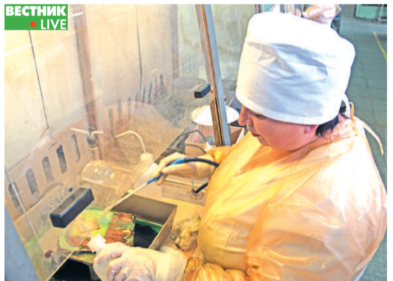
Татьяна Фисенко, аппаратчик производства изотопов, проводит съём с приёмника иттербия-176.
