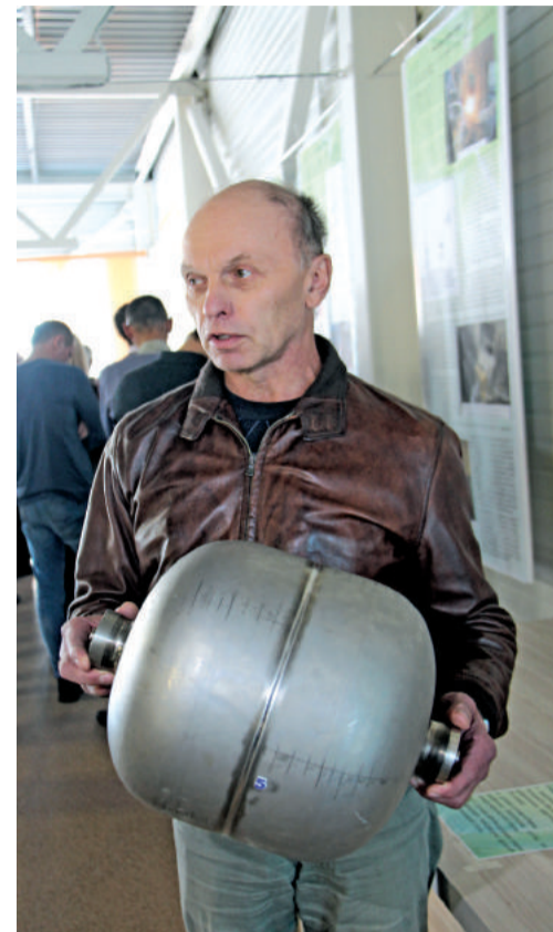
Александр Дмитриев, ведущий инженер службы специализированных лабораторий комбината «Электрохимприбор»: «Вот такие титановые сосуды в качестве элементов топливной системы орбитальных аппаратов и международных космических станций изготавливаются на комбинате уже много лет».
