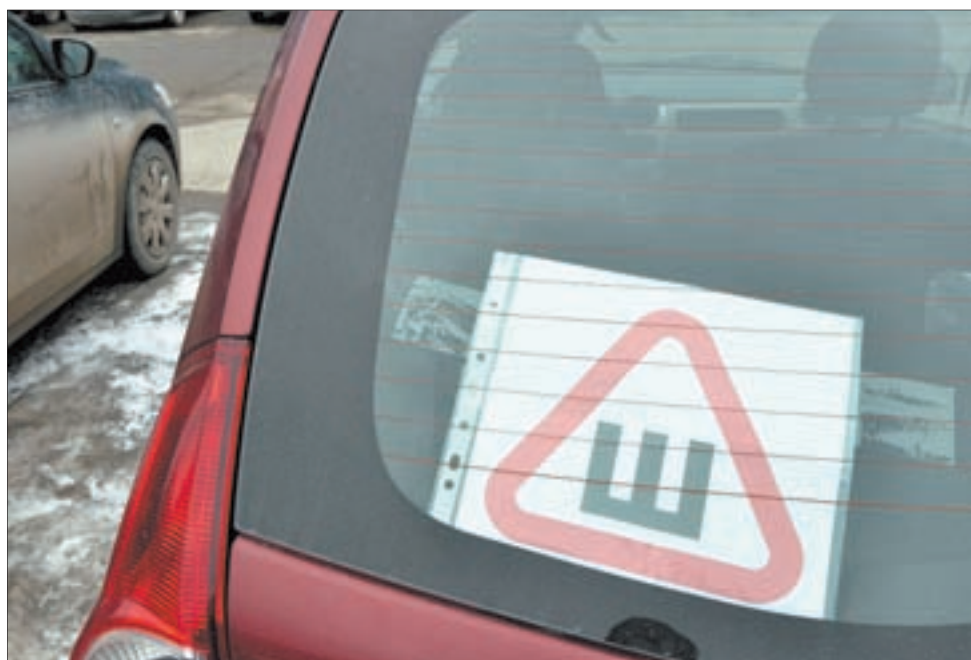
КАК ДОЛЖЕН ВЫГЛЯДЕТЬ ЗНАК «ШИПЫ». По ГОСТу, это равнобедренный треугольник белого цвета вершиной вверх с каймой красного цвета, в который вписана буква «Ш» черного цвета (сторона треугольника — не менее 200 мм, ширина каймы 1/10 стороны).
