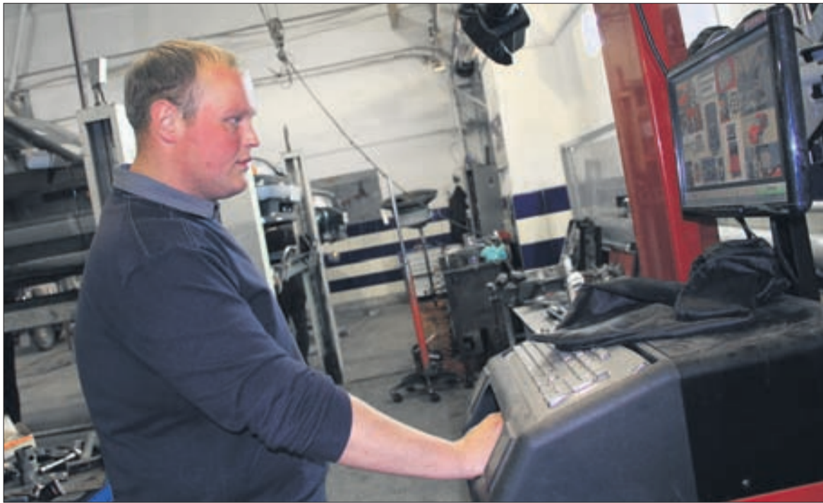
Управляющий автосервисом Андрей Копытов демонстрирует стенд с компьютерным развал-схождением, который позволяет делать более точную настройку колес
