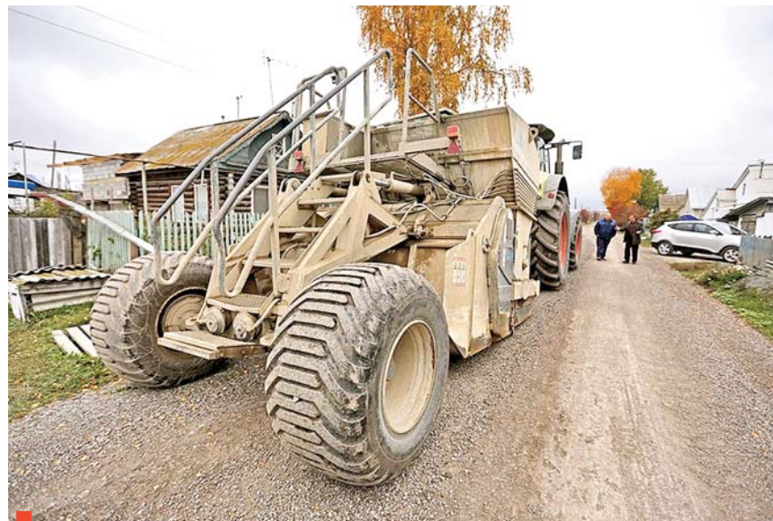
Беспылевой комплекс позволяет строить дороги по новой технологии даже в населенных пунктах
