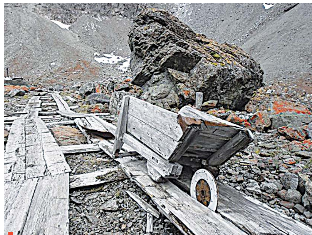
Экспонат «музея под открытым небом». Заключенные рудника Мраморный возили урановую руду в этой деревянной тачке, направляя ее по деревянному же настилу
