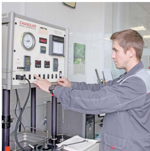
Контроль качества тампонажного цемента на термобарическом консистометре
