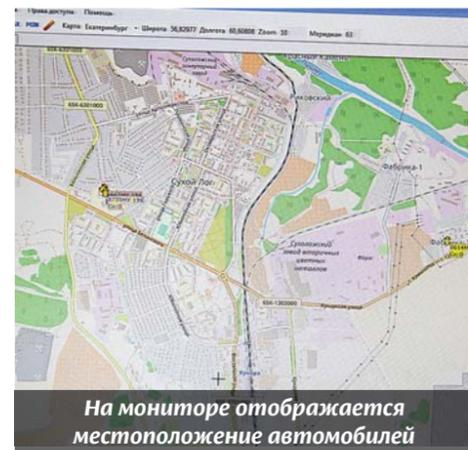
На мониторе отображается местоположение автомобилей
