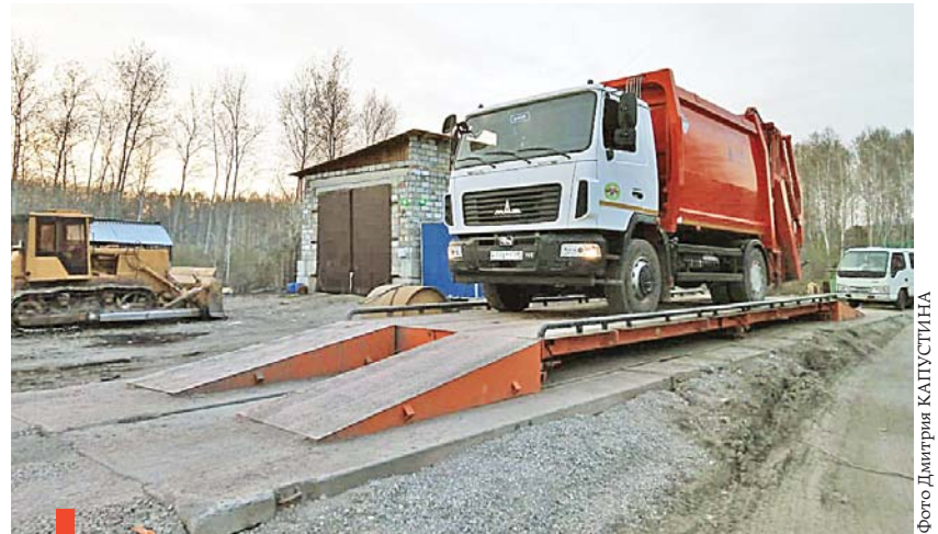
Автоматические весы точно определяют реальный вес отходов
