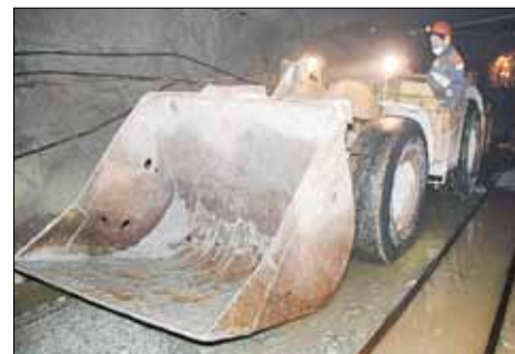
Машинист погрузочно-доставочной машины А. Головзин ведет уборку забоя на дайке Андреевская, 412-й горизонт. Фото Ксении Усачёвой
