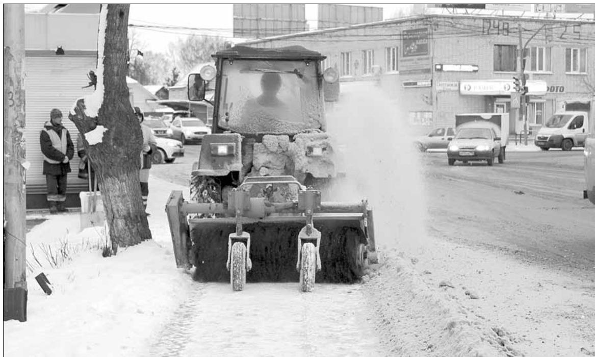
«Беларус 320-Ч.4» может одновременно и сгребать снег, и подметать дорогу щёткой, при этом помещаясь на тротуаре со всеми колёсами. Фото Валентины Завойской
